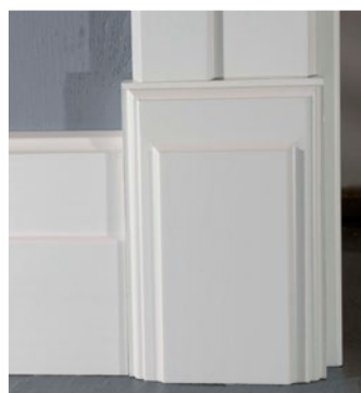
Bunn-/sokkelkloss for karmlist tilpasset karmlist med inntil 15mm tykkelse og 70mm bredde. Gulvlist skal ikke overstige 15mm tykkelse og 95mm bredde.
